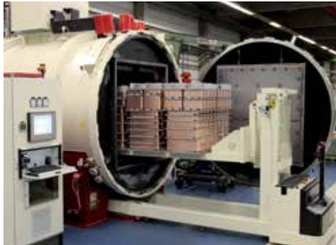
Hochvakuum-Lötofen mit einem Chargengewicht von 3,5 Tonnen. High-vacuum brazing furnace with batch weight of 3.5 tonnes.
